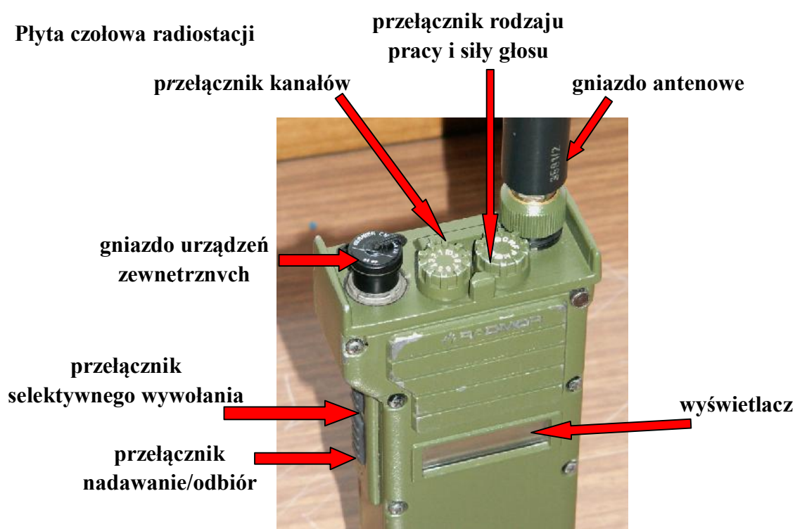
Rys. 98. Płyta czołowa radiostacji R - 3501
