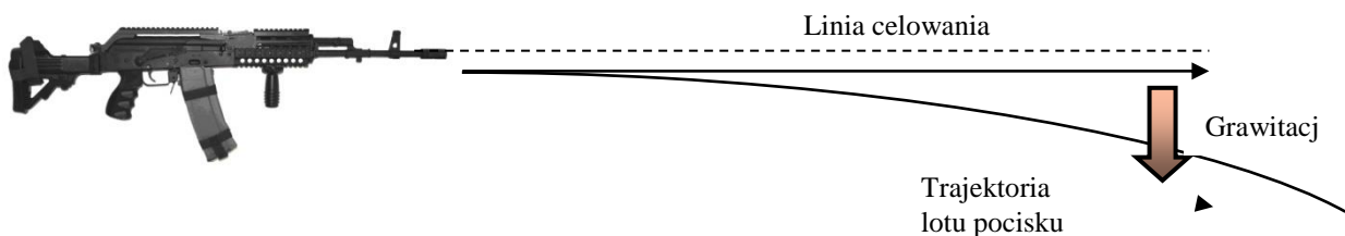
Rys. 11. Grawitacja powoduje odchylenie toru lotu pocisku ku dołowi.
