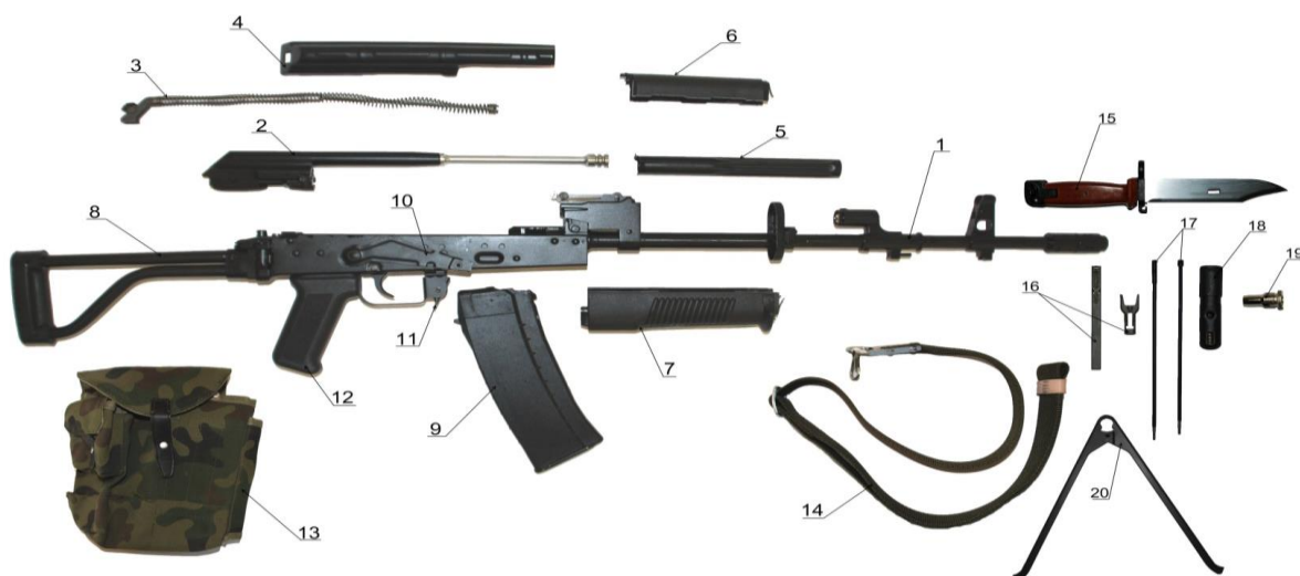
Rys. 15 Widok ogólny 5,56 mm karabinu szturmowego – wariant A;
