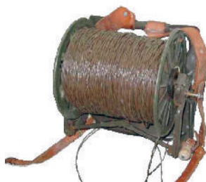
Fot. 61. Zespół polowego kabla lekkiego ZPKL 1x2. Źródło: Opracowanie własne.
