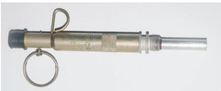
Fot. 126. Zapalnik o działaniu odciągowym do miny MON-100 składający się z: mechanizmu uderzeniowego MUW-2 oraz zapalną MD-5M.
