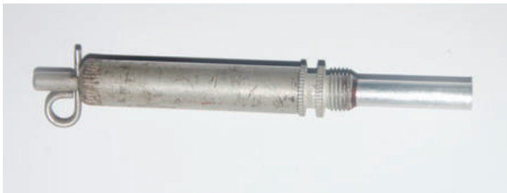
Fot. 112. Zapalnik o działaniu odciągowym do miny POMZ-2M składający się z: mechanizmu uderzeniowego MUW z zapalnika MD-5M.
